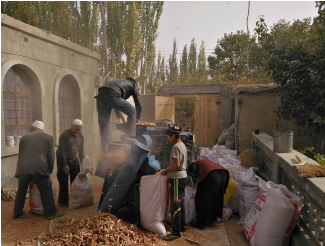
玉米脱粒机，1小时脱粒3吨玉米，每脱粒1吨玉米40元钱。
